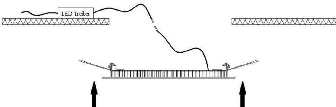
**Schritt 4** Klappen sie Bügel am Panel hoch und schieben Sie das Panel in den Lochausschnitt der Decke
